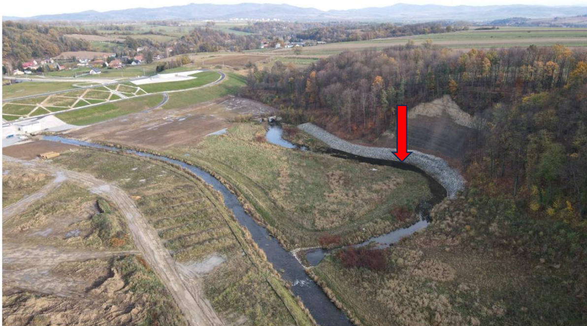
Fot. 16. Widoczny nowy odcinek koryta dopływowego do zapory zbiornika oraz zachowany odcinek koryta Bystrzycy Dusznickiej powyżej zabytkowego mostu (czerwona strzałka) (poz. 53 PZŚ).
